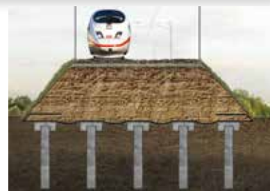
Bewehrung über vertikalen Traggliedern
