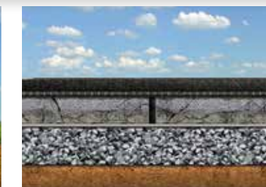
Sanierung von Betonflächen mit Asphalt
