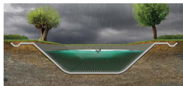
Balsa de retención y almacenamiento de aguas pluviales
