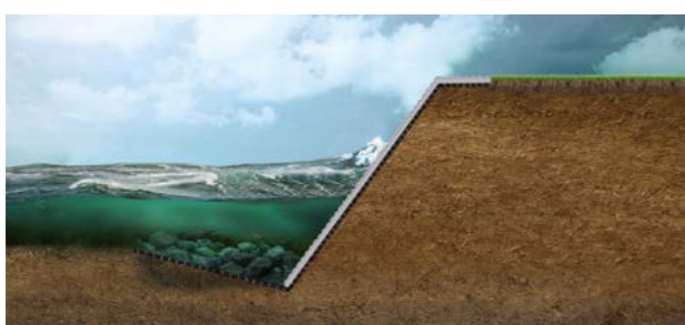
Estabilización de taludes
