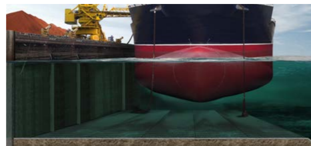
Protección de fondos de puerto
