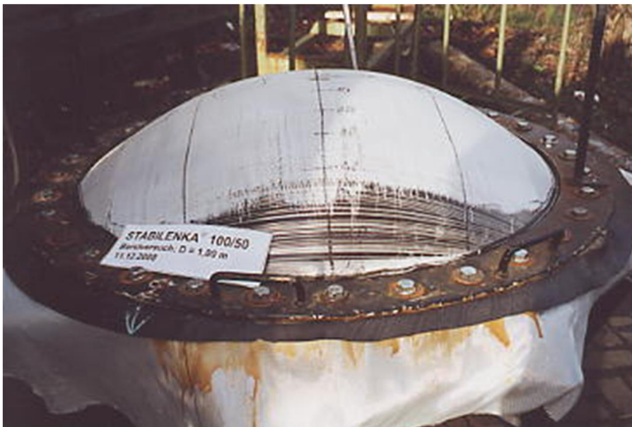
Abb. 14: Berstdruck-Versuch zur Simulation der Verformungen, HUESKER Synthetic (2000) [11]
