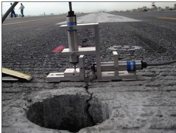
Figura 2 – Medidor de deslocamento “Crack Activity Meter” (CAM).
